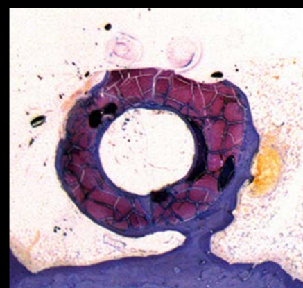
Conversion de la vis MAGNEZIX® CS en phosphate de calcium après 12 mois avec signes clairs d'intégration osseuse.
